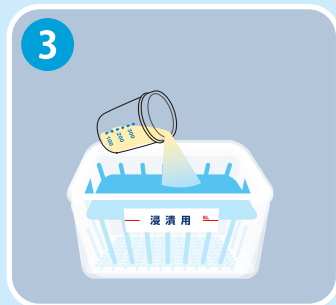
3 浸漬用容器に計量したラバラックインスツルメントを投入(約1300ppmの有効塩素濃度)
