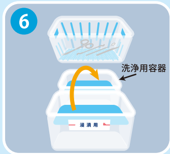
6 5Lの水道水を入れた洗浄用容器にバスケットを移し替える
