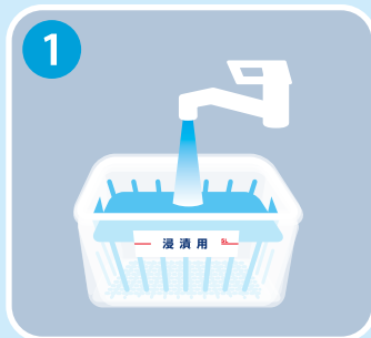
1 浸漬用容器に水道水を5L投入
